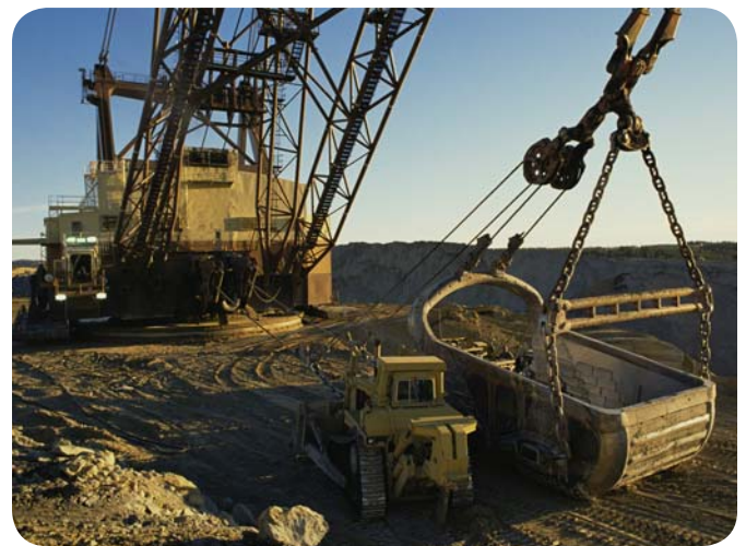
Figure 3 Les pelles à benne traînante comportent des poulies qui facilitent le raclage de grandes quantités de couches de surface.
