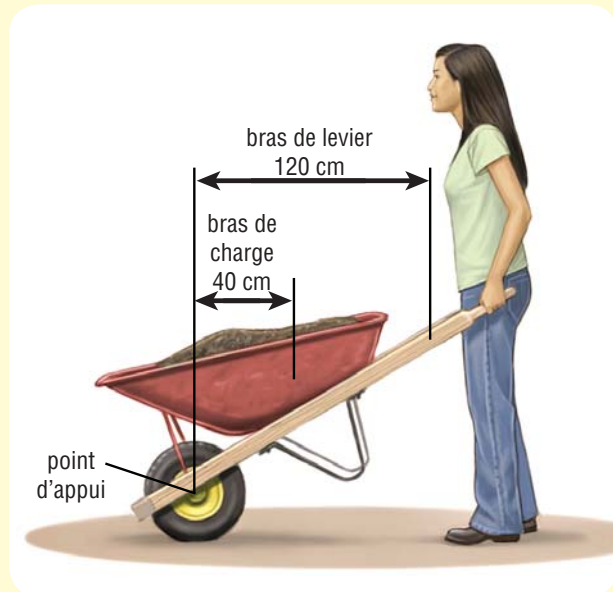
Figure 2 Cette brouette multiplie par 3 la force appliquée.
