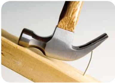
Figure 1 Ce marteau qui retire un clou d'une planche possède un gain mécanique de 15.
