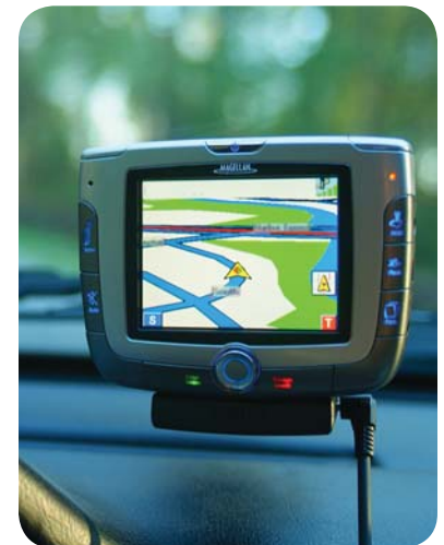
Figure 2 Les récepteurs GPS (sigle anglais de Global Positioning System ) transforment les signaux transmis par divers satellites en renseignements utiles pour les conductrices et conducteurs.
