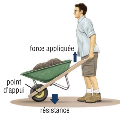
Figure 6 Une brouette est un levier du deuxième type.
